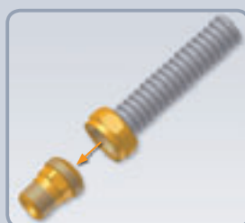
Prepričajte se da je spojna površina čista
